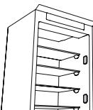
Този уред съдържа 4 странични светлинни източника с клас на енергийна ефективност F и горен светлинен източник с клас на енергийна ефективност G
