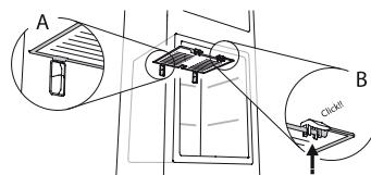
7. Helyezze vissza a felső fiókot, és csukja be a fagyasztótér ajtaját. A JÉGTELENÍTŐ tartozék megtisztítható önmagában is, a fagyasztótér teljes jégtelenítése nélkül. A JÉGTELENÍTŐ tartozék rendszeres tisztítása esetén ritkábban kell végrehajtani a fagyasztótér teljes jégtelenítését.
