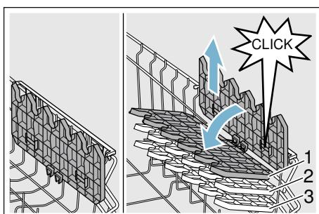
\* В зависимост от варианта на оборудване на Вашата съдомиялна машина можете да променяте положението на етажерката на три степени по височина.
