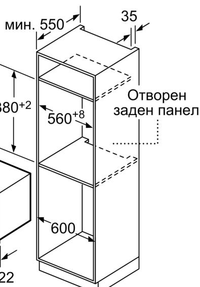
Измерване в мм
