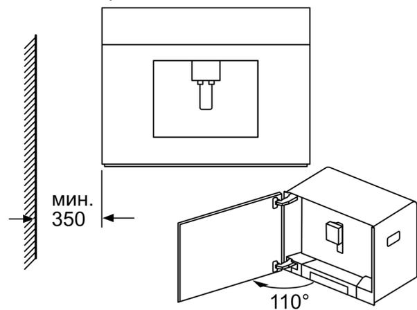
При използване на 92° ограничение за панта (номер на резервна част 00636455) минималното разстояние до стената възлиза само на 100 мм.
